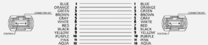
Belegung des Trunkkabels 12-fasrig
